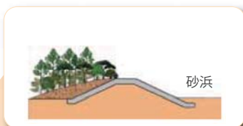
海岸堤防等の整備
